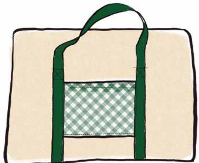
Placer le bord de la sangle en chevauchant le côté de la poche de 1cm, épingler précisément jusqu'au repère pour arrêter la couture de façon symétrique de chaque côté.
